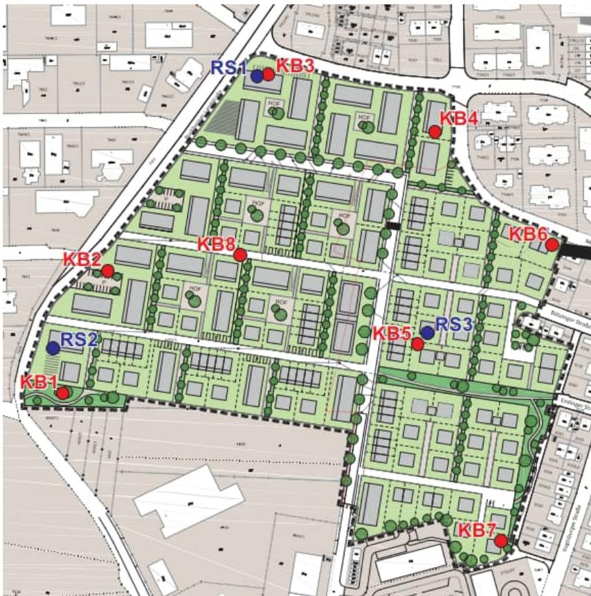
Abbildung 3: Detailplan mit Lage der Baugrundaufschlüsse (KLC, 2017)
